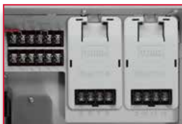
Конфигурация на 12 станций с модулями по (2) 4 станции
