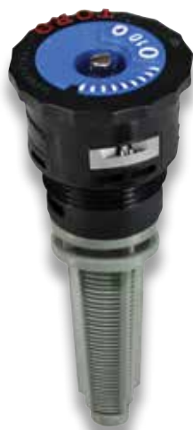
Форсунка высокого расхода делового конкурента: Форсунка 12H при давлении 3,4 бар = 6,93 л/мин или 62 мм/ч.*
